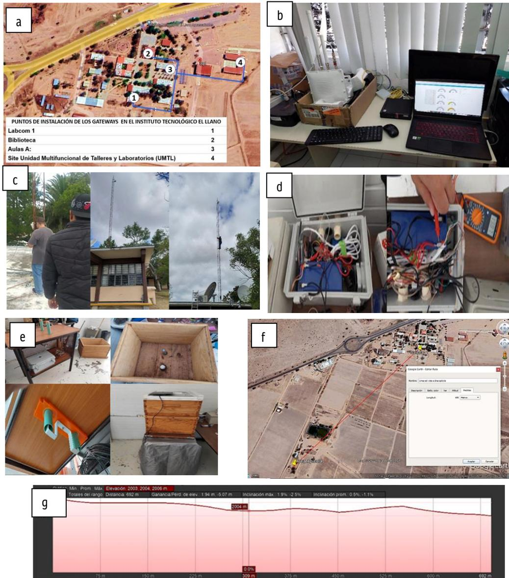
Figura 2. a), Puntos de instalación de los Gateways IoT en el ITEL; b), Configuración de equipo; c), Montaje de Gateway 1 en Torre estructural TZ45 en Labcom 1; d), Integración de caja de protección al ambiente externo; e), Adecuación del prototipo IoT a la colmena experimental; f), Distancia entre el Gateway IoT y el Prototipo IoT y g), Perfil de elevación.
