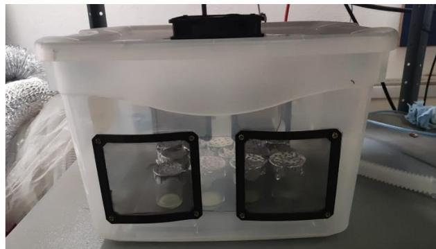
**Fig. 2.** Caja de ventilación utilizada para colocar y permitir la evaporación lenta del solvente utilizado en cada muestra.
