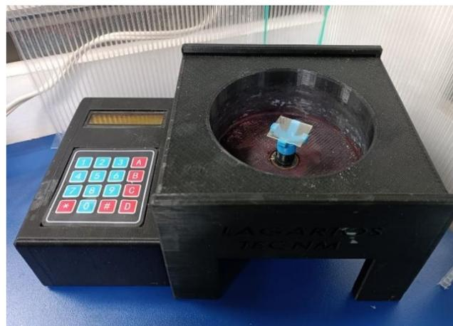
**Fig. 6.** Dispositivo para realizar películas mediante Spin Coating. Su fabricación fue realizada mediante impresión 3D.
