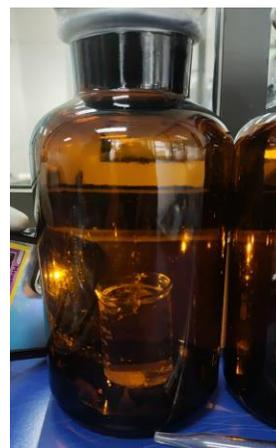
**Fig. 3.** Arreglo con un recipiente que contiene un antisolvente y un vaso de precipitado con la solución precursora.
