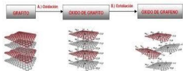
**Fig. 2.** Representación esquemática del Grafito al Óxido de Grafeno.
