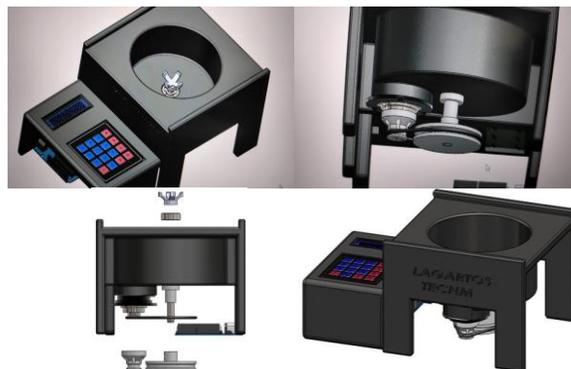
**Fig. 5.** Diseño de dispositivo para realizar películas mediante Spin Coating para su posterior fabricación mediante impresión 3D.
