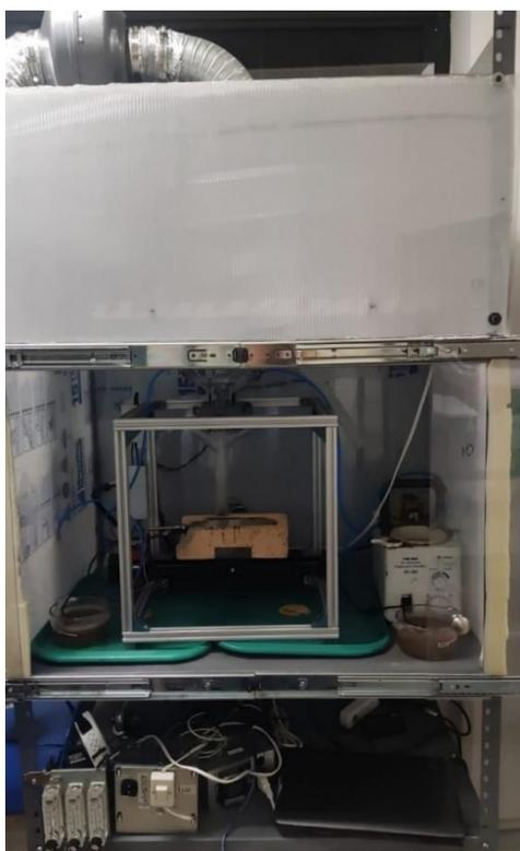
**Fig. 8.** Sistema de rocío pirolítico ultrasónico implementado en el Instituto Tecnológico de Tlalnepantla.
